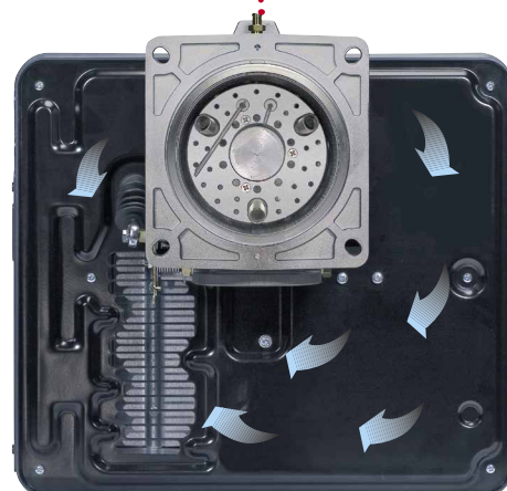
HCS (外壳冷却系统)工作原理示例。
